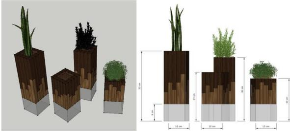
**Gambar 5.** Sketsa dimasukkan ke dalam bentuk 3d modelling untuk pembuatan gambar kerja
